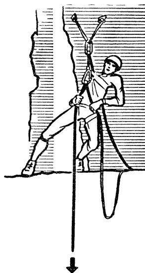
Рис. 193. Правильное соотношение линии рывка к само страховке
