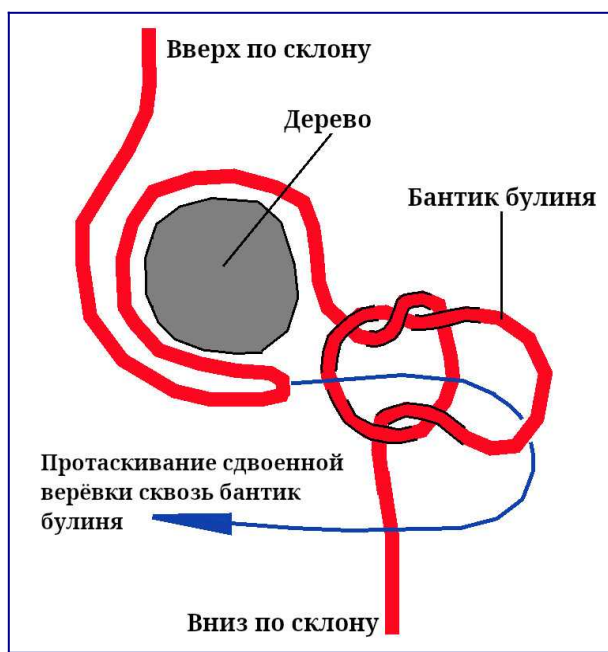
Рис 8. Обвязка дерева узлом голландский булинь на середине верёвки.
